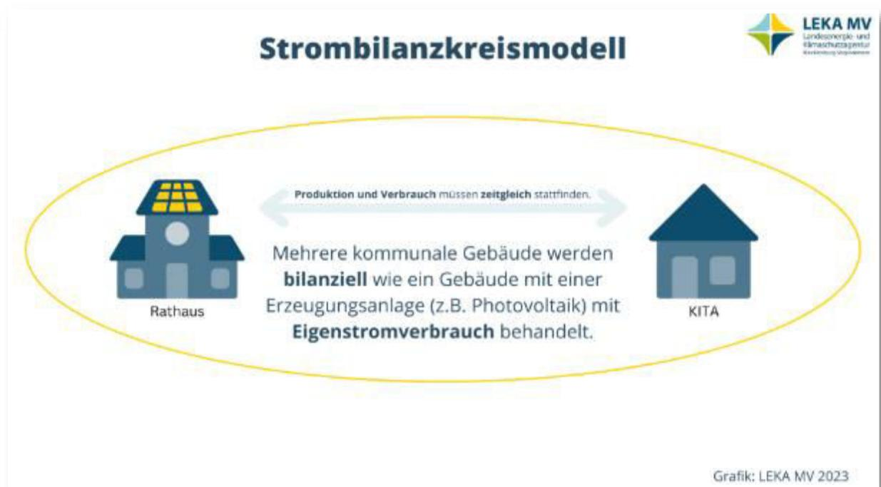
Abb. 76: Prinzip Strombilanzkreismodell
